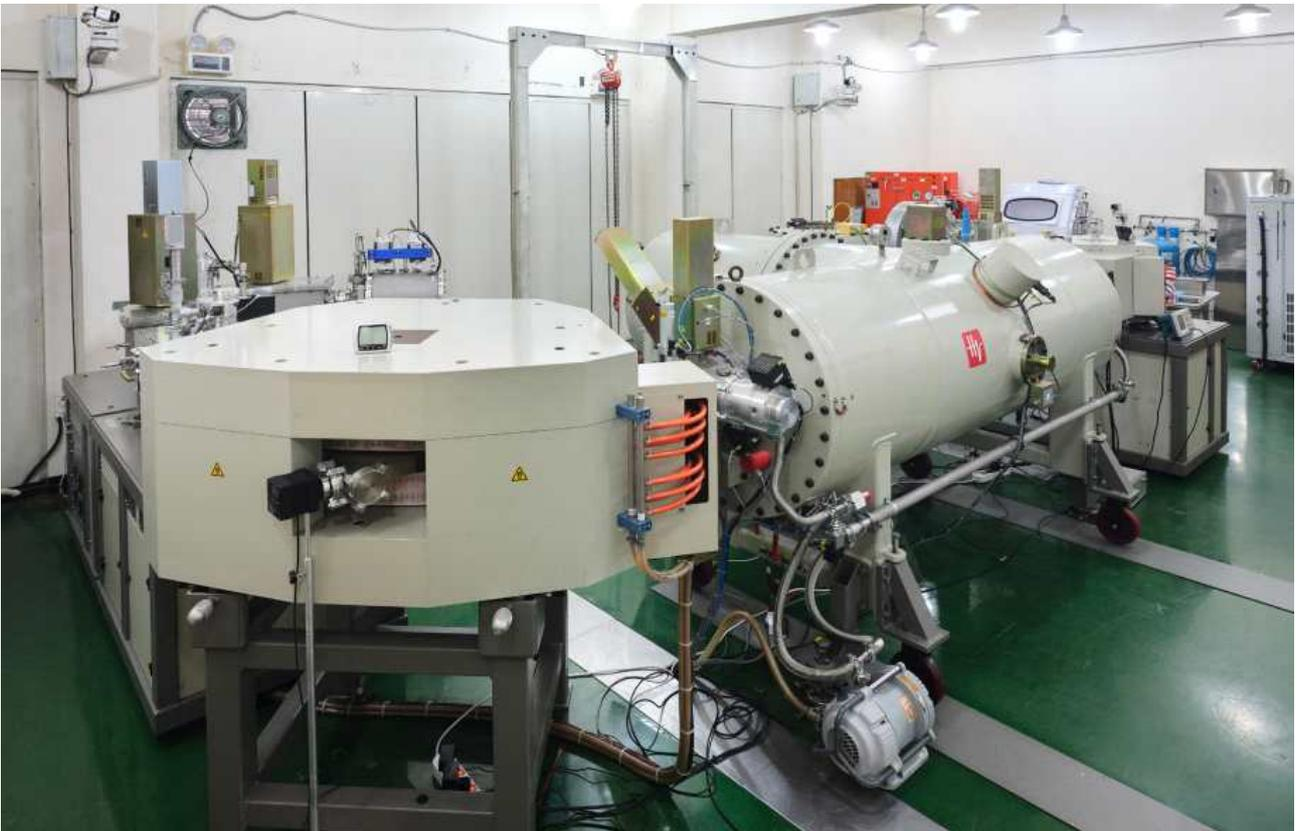
[유기물 및 지질의 연대를 측정하는 AMS (Accelerator Mass Spectrometry) 장비]
